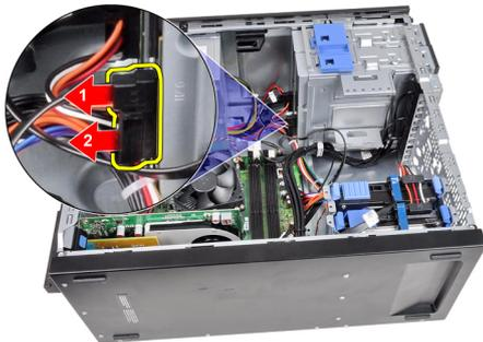
5. オプティカルドライブのラッチを下向きにスライドさせ、コンピューターの背面から前面に向かってオプティカルドライブを押し出します。
