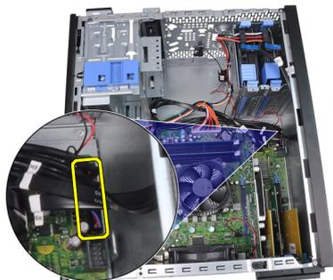
5. コンピューターのクリップから入力/出力パネルとフライトワイヤケーブルを抜き取ります。
