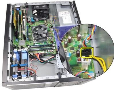
4. システムファンをコンピューターの背面に固定する4つのハトメから取り外します。
