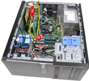
5. **PCIe x1** 拡張カードをコネクタから持ち上げて外し、コンピューターから取り外します。
