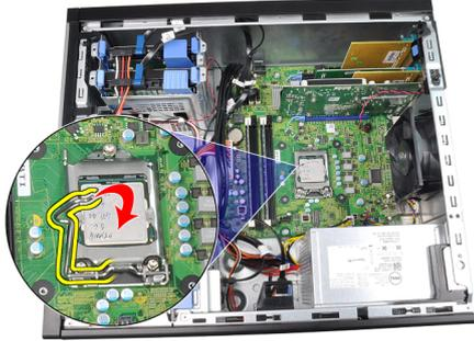
8. プロセッサを持ち上げてソケットから取り外し、静電防止パッケージに入れます。
