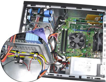
5. 24ピン電源ケーブルをシステム基板から外します。
