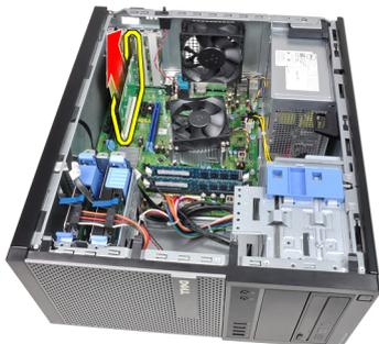
7. **PCI x4** 拡張カードをコネクタから持ち上げて外し、コンピューターから取り外します。
