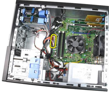
6. 4ピン電源ケーブルをシステム基板から外します。
