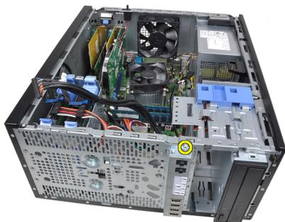
7. 入力/出力パネルをコンピューターの左に向かってスライドさせ、固定を解除します。
