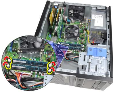
4. システム基板上のコネクタからメモリモジュールを引き上げます。
