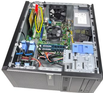
6. **PCI** 拡張カードをコネクタから持ち上げて外し、コンピューターから取り外します。
