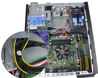
6. 入力/出力パネルをコンピューターに固定するネジを取り外します。
