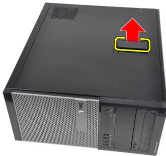
3. カバーを 45 度の方向に持ち上げ、コンピューターから取り外します。
